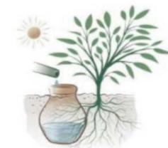
Jarres d'irrigation munies d'un couvercle, les poteries d'arrosage Oyas® sont des céramiques en terre cuite. Remplies d'eau, elles sont suffisamment poreuses pour que la terre qui les entoure puisse absorber l'humidité suintant de la poterie.
